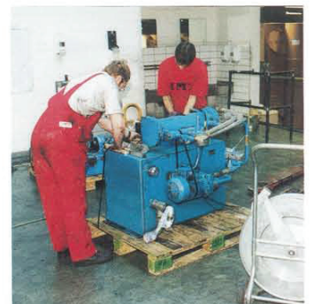
Verspannen eines Öltanks auf Palette für den späteren Transport ins Zwischenlager.
