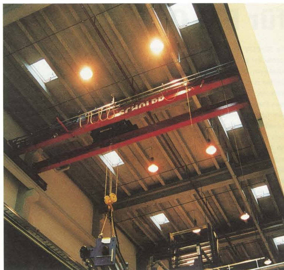
Der temporäre SCHOLPP-Hallenkran beim Verheben und Positionieren der Maschinengruppen.
