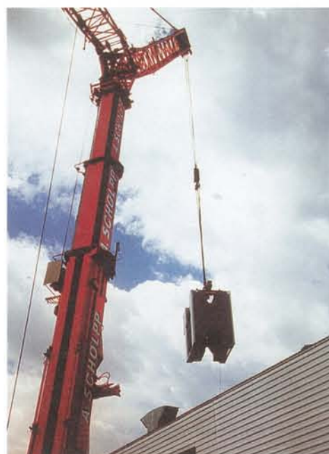
17 m Ausladung und 33 to Gewicht stellten für den HK 270 kein Problem dar.
