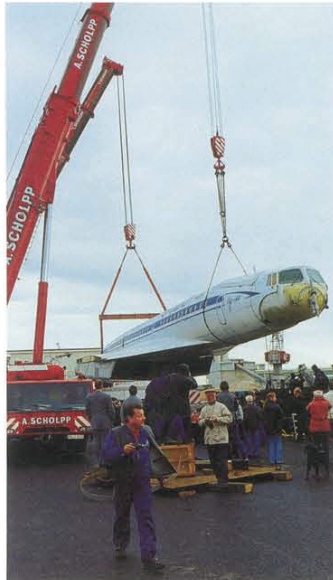
Die auf 48 m gekürzte Tupolev am Kranhaken.
