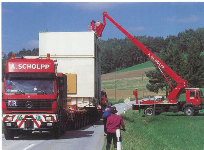
Freiluftleitungen mussten angehoben werden, um die Durchfahrt zu ermöglichen.
