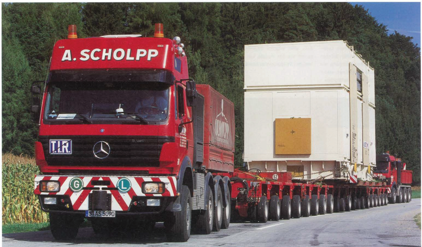
Die 50 m lange Schwerlastkombination mit Zug- und Schubmaschine.
