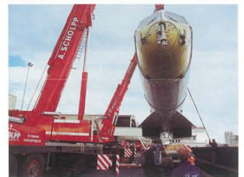
Die SCHOLPP-Krane laden den Flugzeugrumpf im Hafen Heilbronn auf eine Spezial-Kesselbrücke.
