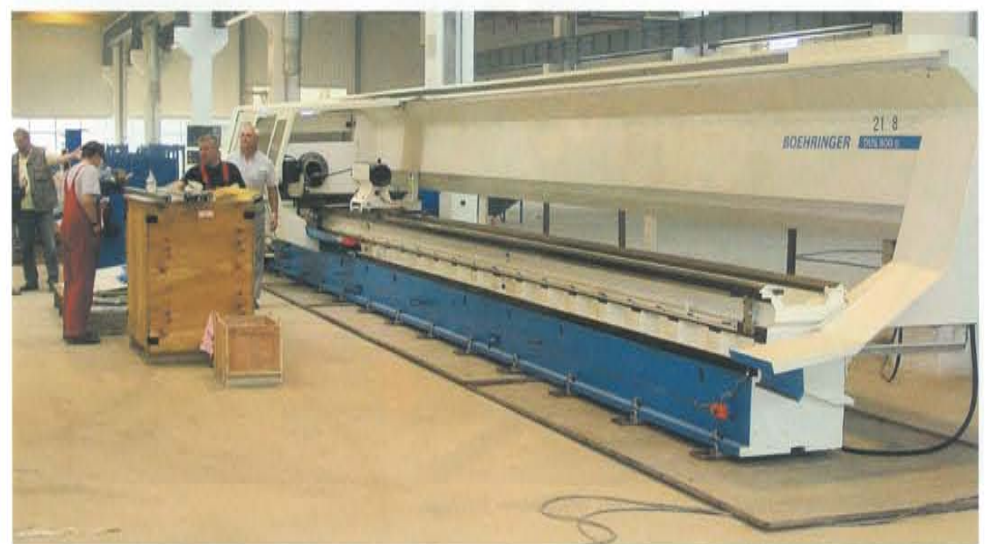
Das Feinausrichten der langen Boehringer Drehmaschine war am anspruchsvollsten.
