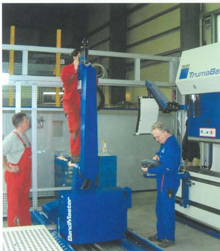
Einstellarbeiten am Bendmaster.
