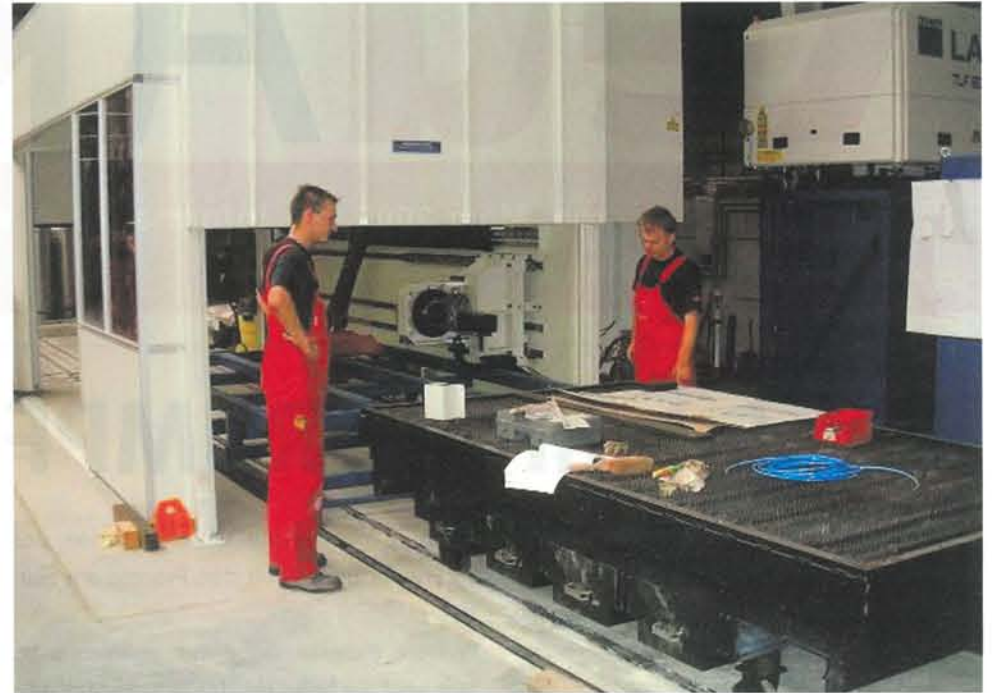
Montage einer TLC 1005 mit verfahrbarem Tisch.
