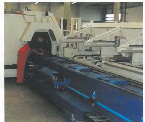
Letzte Justage-Arbeiten an einer Rohrbearbeitungsmaschine Tubematic.
