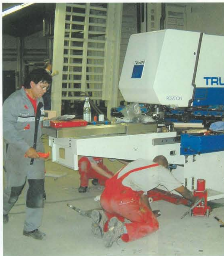
Demontage einer Stanzmaschine Trumatic 500.
