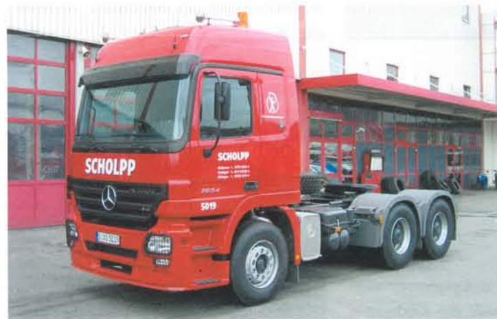
Eine neue Sattelzugmaschine für Heilbronn - Mercedes Actros 2654 6x4 LS: Bärenstarke 540 PS bei 1800 U/min und ein bulliges Drehmoment von 2500 Nm.
