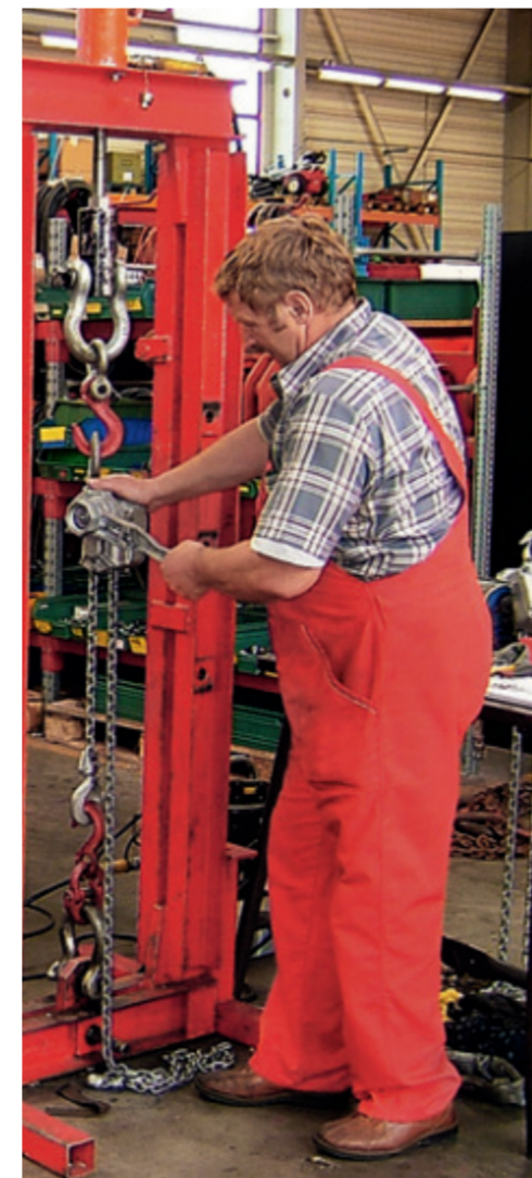
Alle Hebezeuge werden mindestens einmal jährlich mit unserer mobilen Prüfstation kontrolliert
