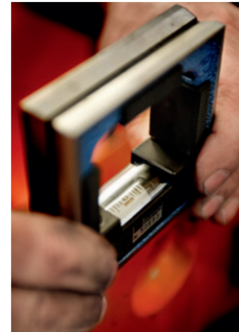
Präzision auf Hundertstel Millimeter: Einmessen der Bearbeitungsmaschine
