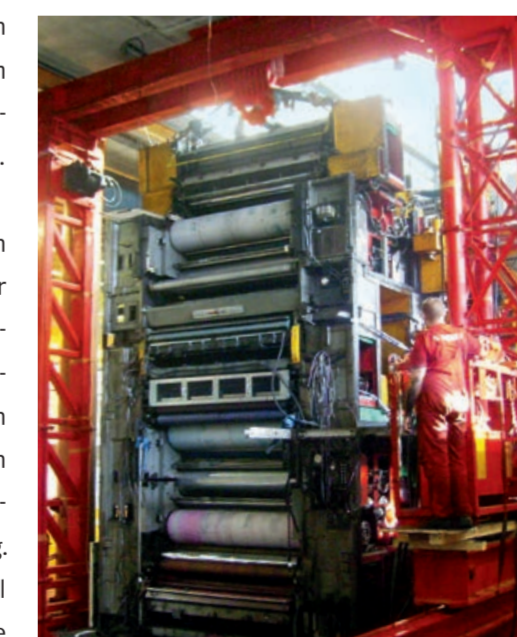
Das an die räumlichen Gegebenheiten angepasste 50-Tonnen-Seilzugportal war ein wichtiger Akteur bei der Demontage der WIFAG OF 370 und OF 7
